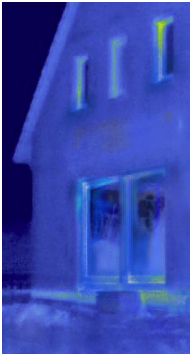
Nakon renoviranja: primjena podizno-kliznih vrata GENEEO znatno umanjuje gubitke topline.
